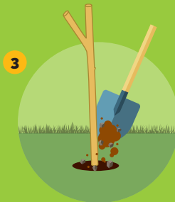
3 Llenar los pozos con tierra y piedritas
