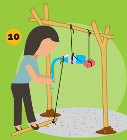
10 Pisar el palo para volcar el agua de la botella. Colocar las piedritas abajo para que absorban ese líquido
